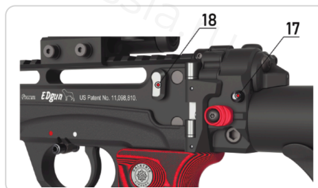
Рычаг 18 и зацеп 17: раскладывание из сложенного положения
